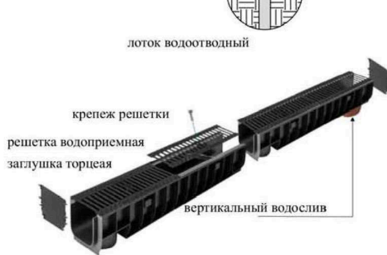
Схема установки водоотводного лотка в мощении
