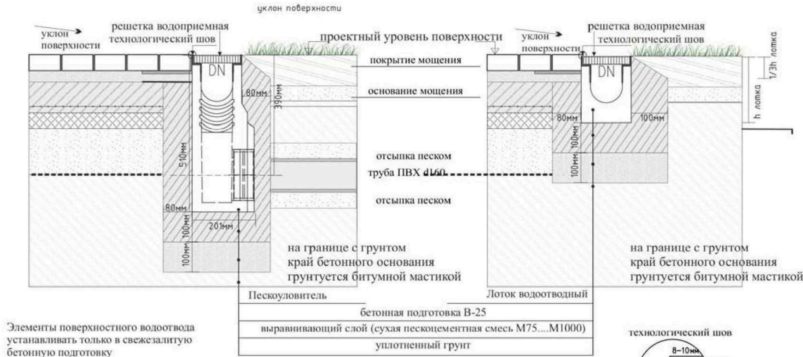
Схема установки пескоуловителя по краю мощения
