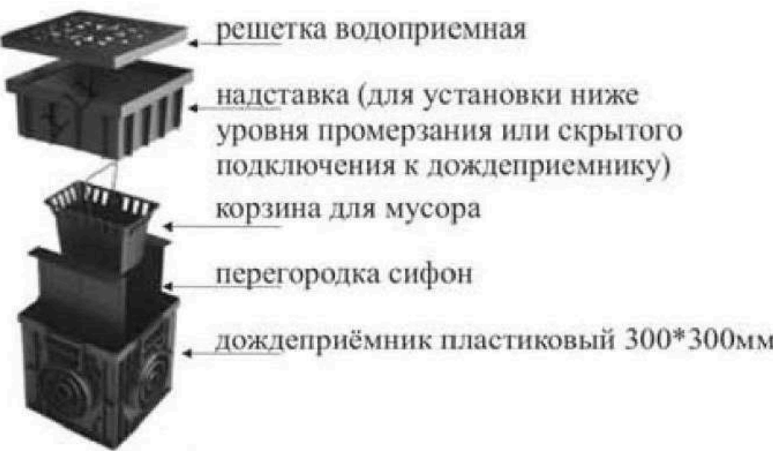
Элементы дождеприемника
