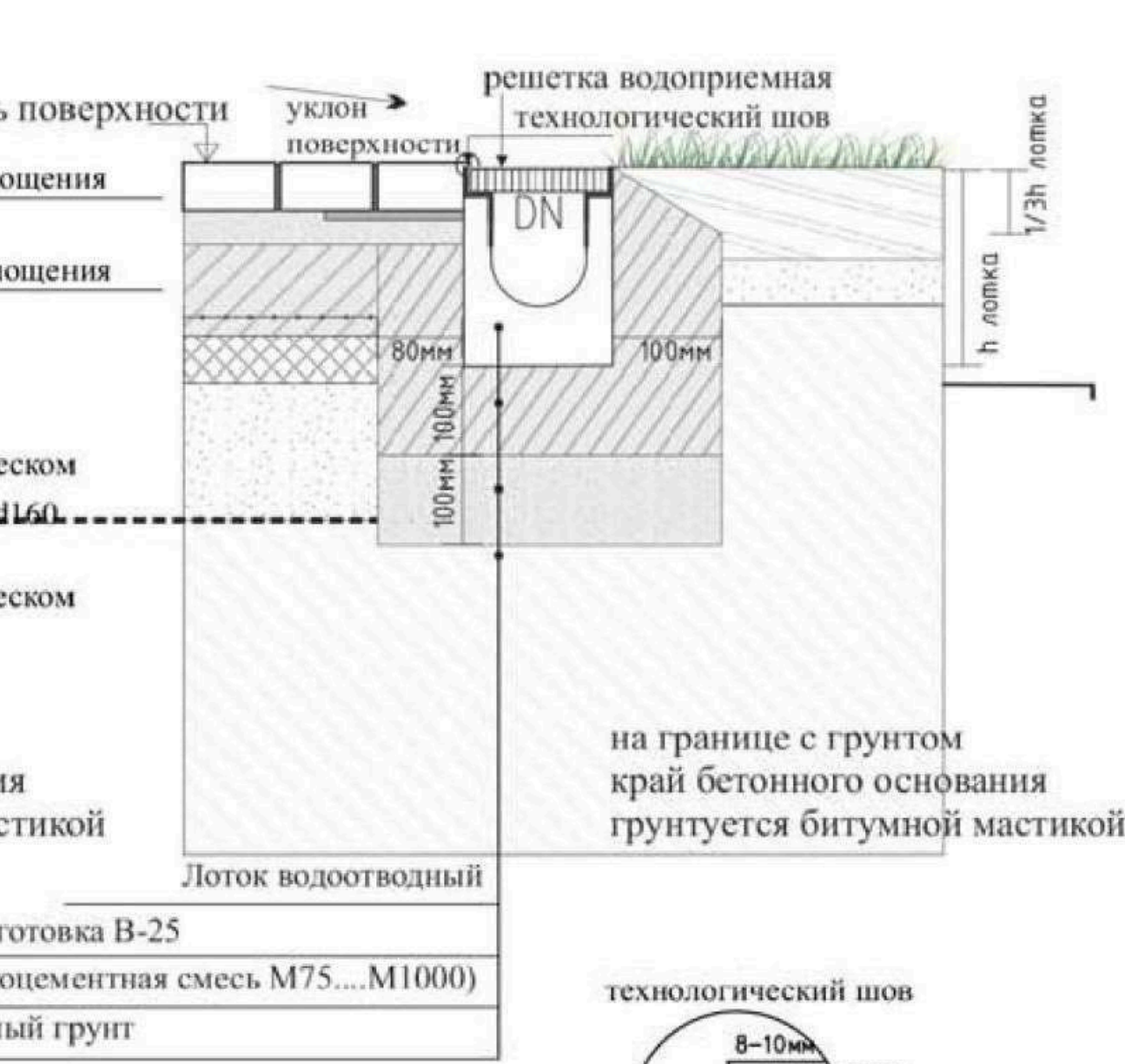
Схема установки водоотводного лотка по краю мощения
